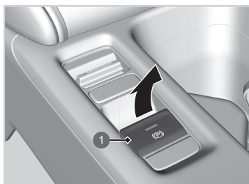
❶ Comutatorul frânei de parcare
